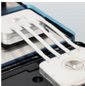
Prismatische Zellen verbunden mit Ribbons aus Aluminium
