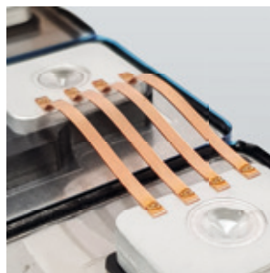
Prismatische Zellen verbunden mit Ribbons aus Kupfer
