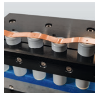
TAB-Bonds gleichen unterschiedliche Zell-Höhen aus
